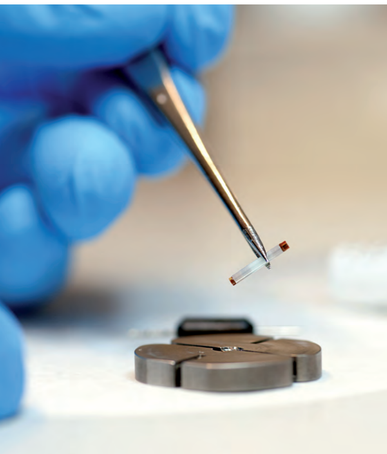
Die Rotoren, die in der Festkörper-NMR verwendet werden, sind winzig. Dieser hat einen Durchmesser von 1,3 Millimetern.
